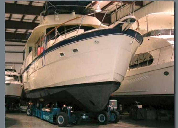
El diseño en "U" permite la elevación directa de la embarcación desde el lugar de varada sin necesidad de maniobras previas. Su diseño asegura que el transporter se convierta en una herramienta vital para la productividad del varadero.
