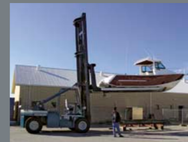
El mando remoto permite que un solo operario pueda efectuar las tareas de varada.
